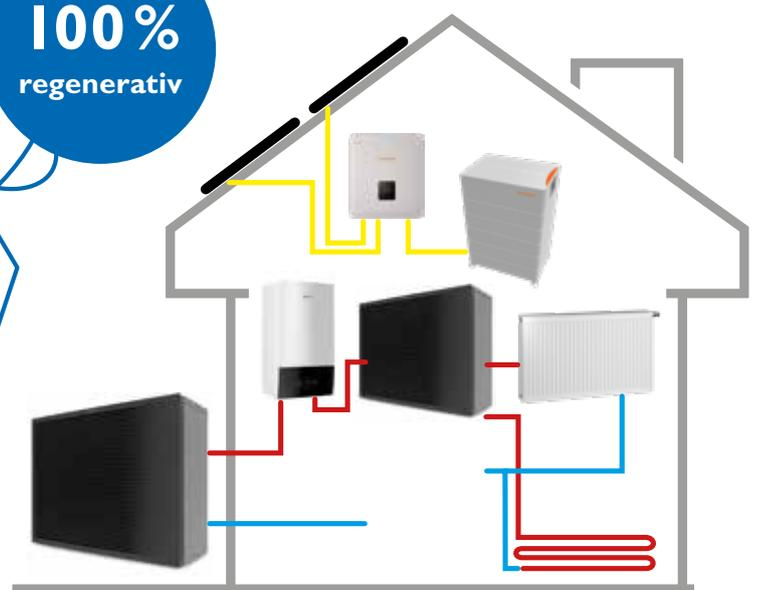
Luft/Wasser-Wärmepumpenanlage 8 kW mit PV-Anlage und Batterie
